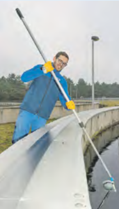
Qualitäts-Check: Marinus van Zyl nimmt mit einem Schöpfbecher eine Probe aus einem Nachklärbecken. Abwasseranalysen sind Tagesgeschäft auf den Kläranlagen.
