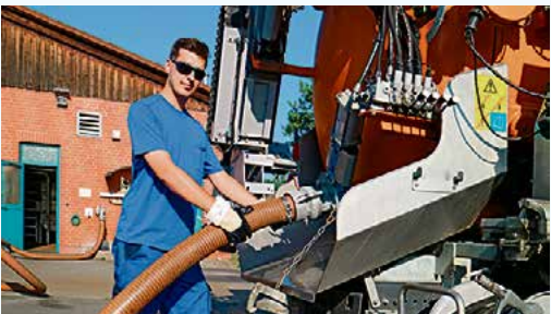
Zulauf: Kanalnetzmitarbeiter Patric Schindler leert den Tank des Saug- und Spülwagens. Ein Teil des Abwassers kommt per Fahrzeug zum Klärwerk, das meiste aber über die Kanalisation.
