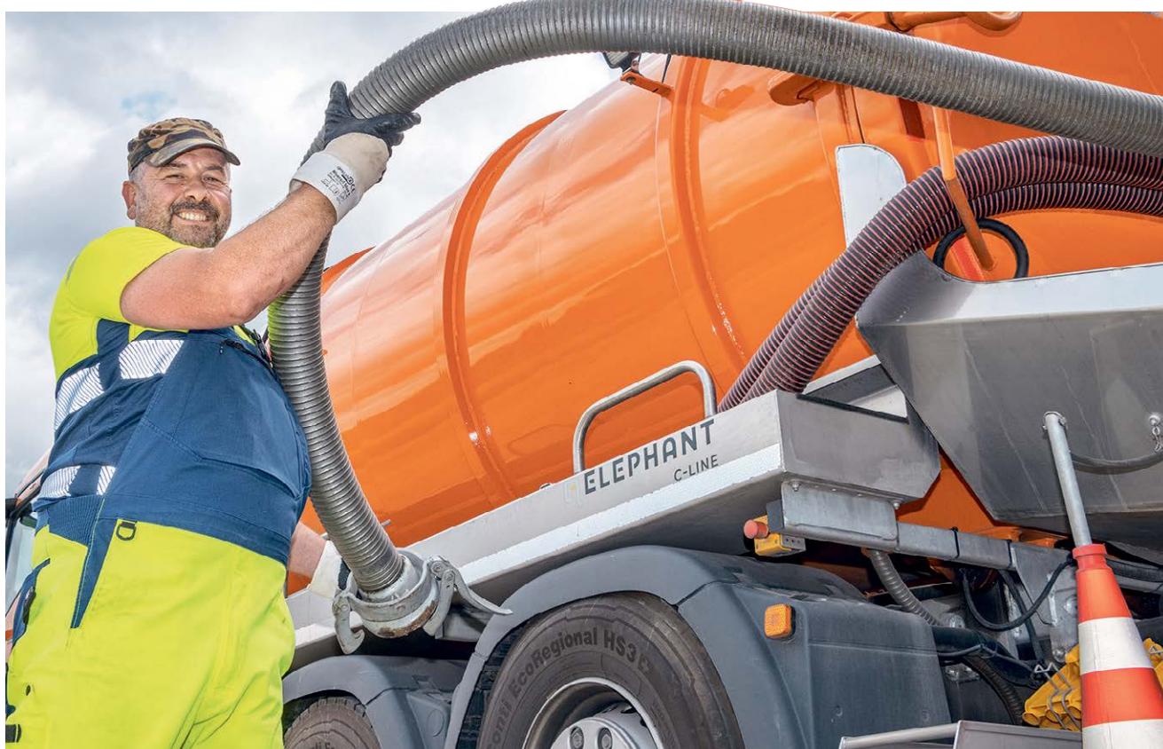
Die Männer der dezentralen Entsorgung beim ZVWA müssen nicht nur aufmerksame Kraftfahrer, sondern auch körperlich fit sein. Schließlich wollen die schweren Schläuche zügig bewegt und passgenau an Grube oder Ansaugstutzen platziert sein.
